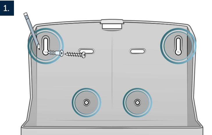
à la hauteur souhaitée grâce à un minimum de 4 vis, généralement à 48 po au-dessus du sol ou à 12 po au-dessus du comptoir (**Figure 1**). Veuillez vous référer aux directives locales de l'ADA pour le placement final.
