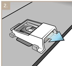
3. Stützen Sie die Verriegelungseinheit von unten mit der Hand ab. Verwenden Sie einen Schlitzschraubenzieher, um die Halteklammer zu entfernen. Das Schloss könnte in die Hand fallen.
