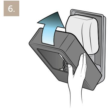
6. Schließen Sie die Abdeckung vollständig und vergewissern Sie sich, dass sie einrastet.
